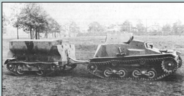
Een prototype Type 94 met een kleinere toren en een desinfecteer aanhangertank waarmee vijandelijke strijd gassen werden bestreden.
