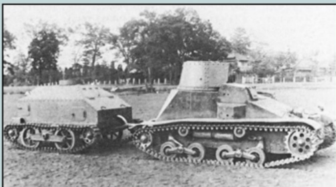
Een prototype Type 94 TK met een aanhangertank waarmee chemische strijd gassen konden worden verspreid.
