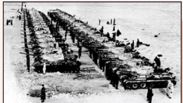
Alle 40 tanks van het "Dmitryi Donskoi" bataljon: 19 T-34/85 tanks en 21 OT-34/76 vlammenwerpertanks.
